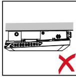
Den Wechselrichter nicht an der Decke montieren.
