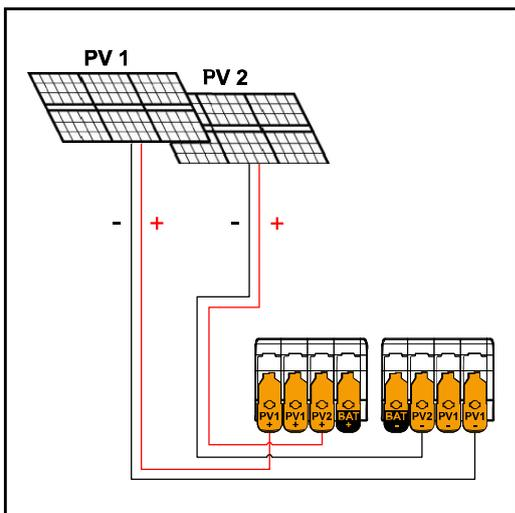
PV 1 kleiner/gleich 40 A ( $I_{SC\ PV1}$ )
