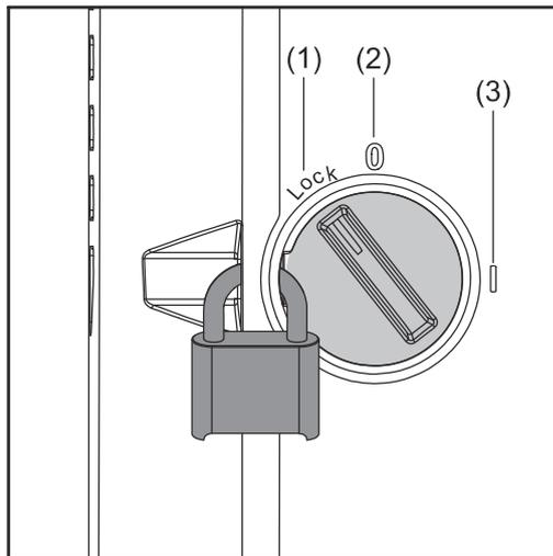
Der DC-Trennschalter verfügt über 3 Schalterstellungen:
