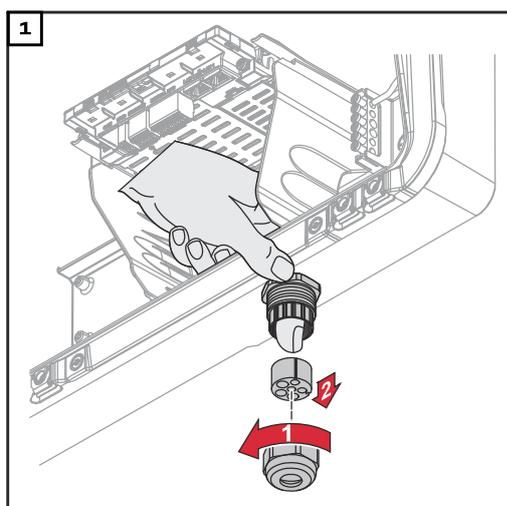
Überwurfmutter der Zugentlastung lösen und den Dichtungsring mit den Blindstopfen von der Innenseite des Geräts herausdrücken.
