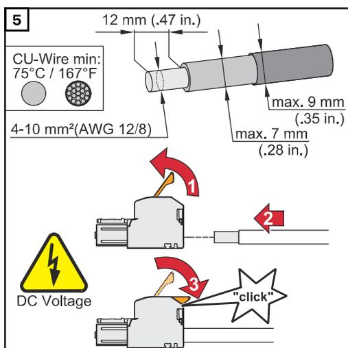
Kabel-Querschnitt gemäß der Angaben in **Zulässige Kabel für den elektrischen Anschluss** ab Seite 66 wählen. Von den Einzelleitern 12 mm abisolieren. Den Betätigungshebel der Anschlussklemme durch Anheben öffnen und den abisolierten Einzelleiter in den jeweils vorgesehenen Steckplatz bis zum Anschlag in die Anschlussklemme stecken. Danach den Betätigungshebel bis zum Einrasten schließen.
