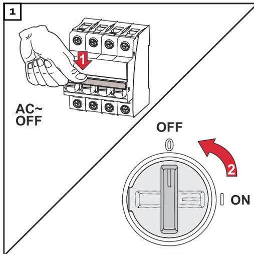
Den Wechselrichter stromlos schalten und die Entladezeit (2 Minuten) der Kondensatoren sowie den Stillstand des Lüfters abwarten. Den DC-Trenner auf Schalterstellung „Aus“ schalten.
