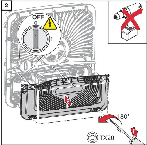
Sicherstellen, dass sich der DC-Trenner in der Schalterstellung „Aus“ befindet.
