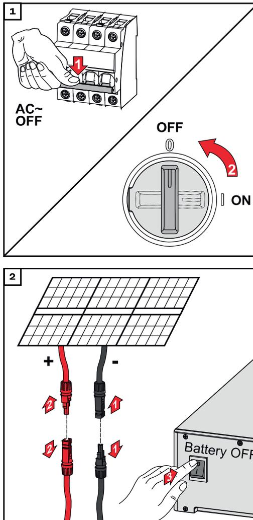
Den Leitungs-Schutzschalter ausschalten. DC-Trenner in die Schalterstellung „Aus“ stellen.
