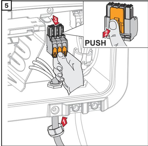
Das Netzkabel von unten durch die Zugentlastung führen.
