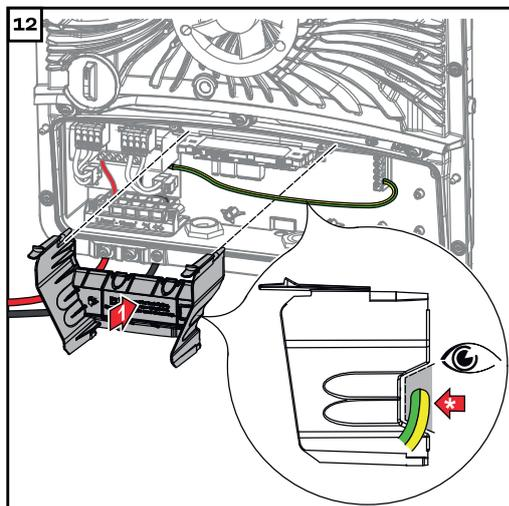
Abtrennung des Anschlussbereichs wieder einsetzen.
