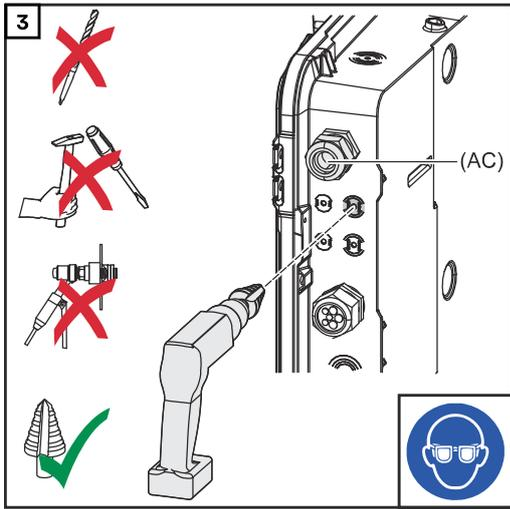
Die optionale Kabelführung mit einem Stufenbohrer aufbohren.
