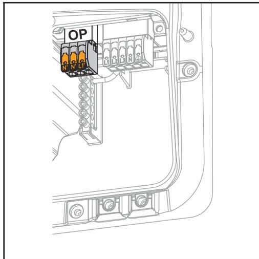
Mit dem PV Point können an der Opportunity Power (OP) Anschlussklemme bei Ausfall des öffentlichen Netzes 1-phasig elektrische Geräte bis zu einer maximalen Leistung von 3 kW versorgt werden, wenn dazu genügend Leistung von den Solarmodulen oder einer optionalen Batterie zur Verfügung steht. An der OP-Anschlussklemme liegt im netzgekoppelten Betrieb keine Spannung an, daher werden in diesem Betrieb die angeschlossenen Lasten nicht versorgt.
